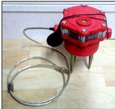
Figura 18 – Tromografo 3D a 4,5Hz.
